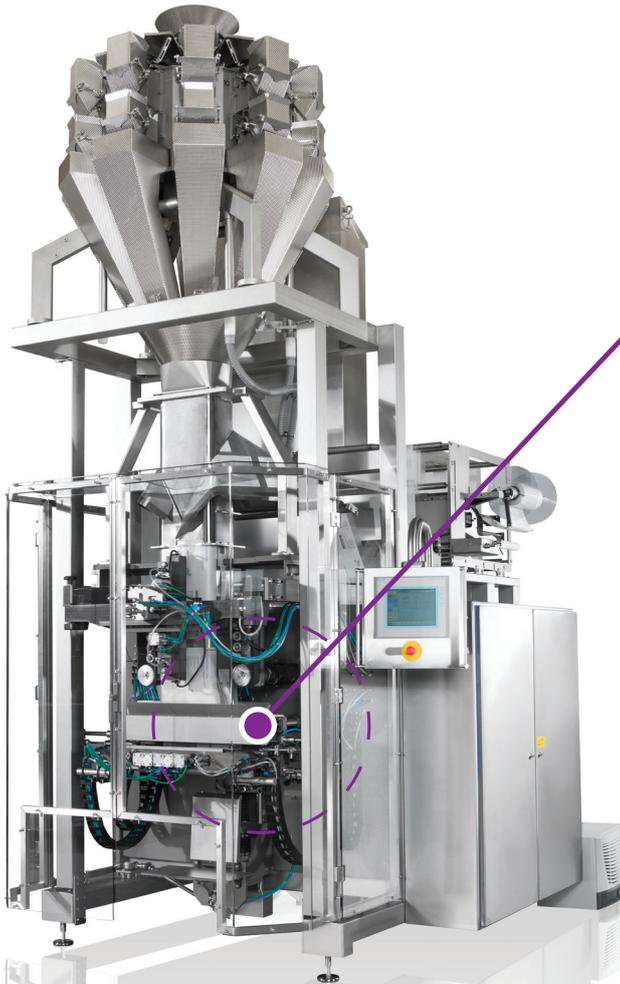
Die vertikale Schlauchbeutelmaschine erzeugt Beutel mit einer Breite von bis zu 600 mm.
